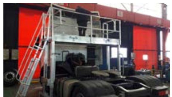
Plate-forme de maintenance pour camions
