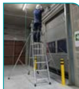
Stabilisateurs à réglage millimétrique.
