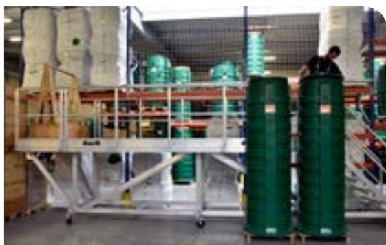
Plate-forme de maintenance pour cuves d'assainissement
