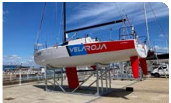
Ber, acier galvanisé, démontable, pour manutention, stockage à sec et transport de voiliers ou de bateaux à moteurs
